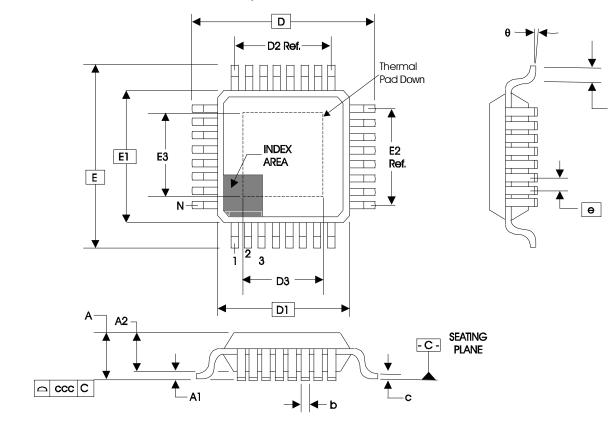
PACKAGE OUTLINE - Y SUFFIX FOR 64 LEAD TQFP, E-PAD
