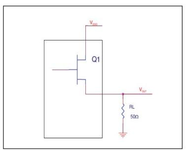
FIGURE 7. HSTL DRIVER CIRCUIT AND TERMINATION
