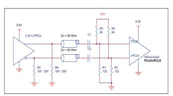
FIGURE 4E. PCLK/NPCLK INPUT DRIVEN BY A 3.3V LVPECL DRIVER WITH AC COUPLE
