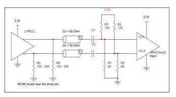
FIGURE 3E. CLK/NCLK INPUT DRIVEN BY 3.3V LVPECL DRIVER WITH AC COUPLE
