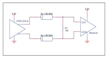
FIGURE 3D. CLK/NCLK INPUT DRIVEN BY 3.3V LVDS DRIVER
